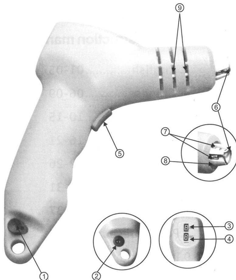
1 – Interruttore di sicurezza; una volta azionato questo, anche se premiamo il bottone di riscaldamento lo strumento rimane spento. Questo eviterà falsi inneschi. Quando lo strumento non è in uso va lasciato con la sicurezza inserita.
