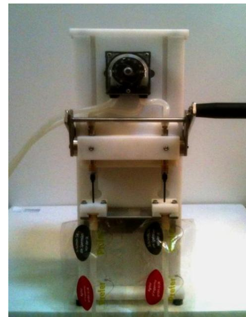
Questa macchina di riempimento è destinata ai centri ed allevatori di piccole e medie dimensioni. Capacità di riempimento 250 PREFER/ora.
