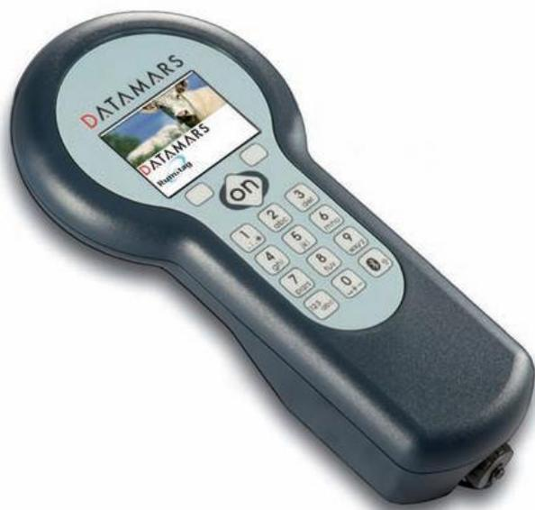
Il nuovo lettore Datamars GES3S è stato appositamente disegnato come dispositivo portatile per l'identificazione di animali da reddito con le migliori performance di lettura. Il GES3S è completamente resistente all'acqua (IP 67), adatto per lavorare in condizioni ambientali difficili e legge transponders ISO FDX-B e HDX in accordo con gli standard ISO 11784/5 e ISO 11784-AMD1.
