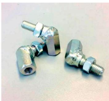
permette una impugnatura più funzionale del flessibile elettrico per dischi
